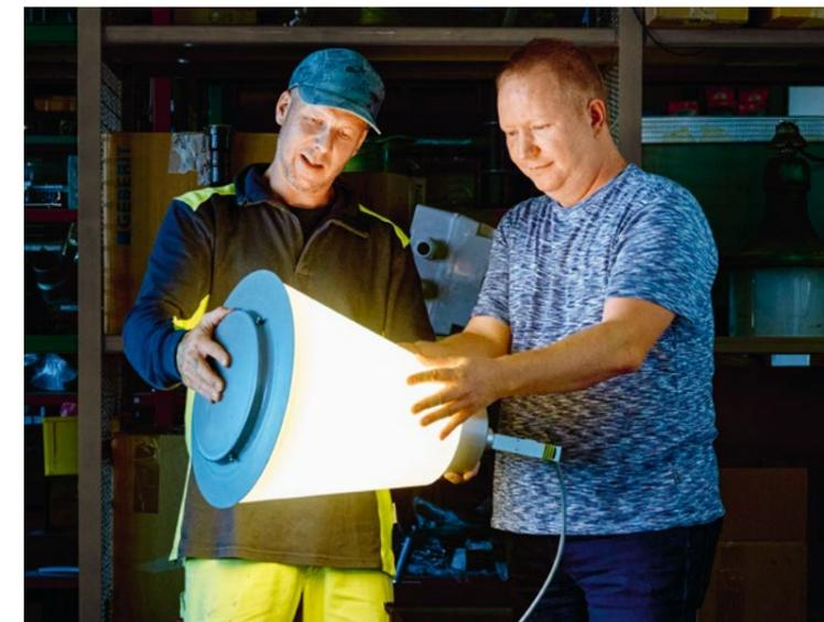
Das sparte Material, Ressourcen und Kosten. Zusätzlich lassen sich die neuen LED-Einsätze dimmen. Das bedeutet: In den verkehrsarmen Zeiten reduzieren wir die Lichtstärke stufenweise. Dadurch sinken Stromverbrauch und Lichtverschmutzung deutlich – ein Plus sowohl für die Umwelt als auch für die Anwohner:innen.
